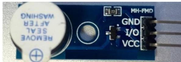
Figure 1: Buzzer module
